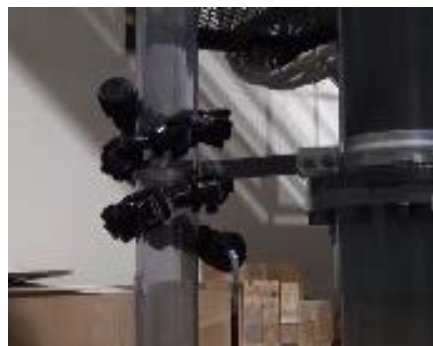
配管外周に巻き付いて移動。フランジや分岐部分も走破可能
