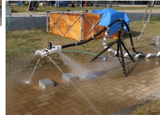
空飛ぶ能動消火ホースロボット
