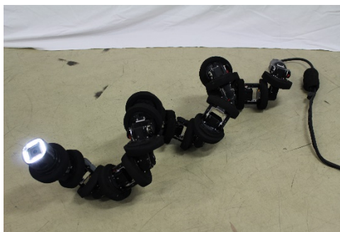
非車輪ヘビ型ロボットの例
