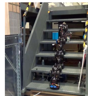
模擬プラントの階段登り
