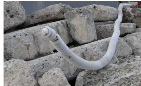
空気浮上を用いた瓦礫内移動
