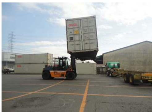
16t フォークリフトでの運搬状況
