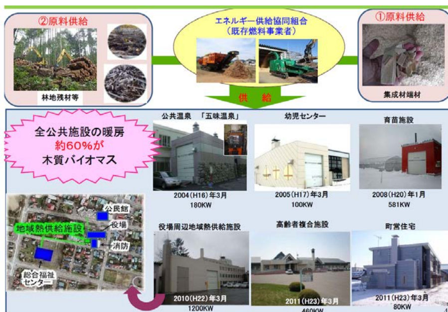
下川町における木質バイオマスボイラの導入状況
