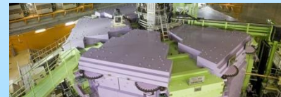
超伝導リングサイクロトロン「SRC」
