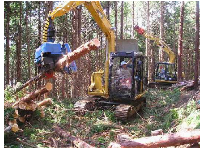
高性能林業機械による集材・造材作業
