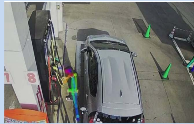
人手不足克服に向けたAI・画像認識技術を活用したセルフSSでの監視システムの開発・実証実験
