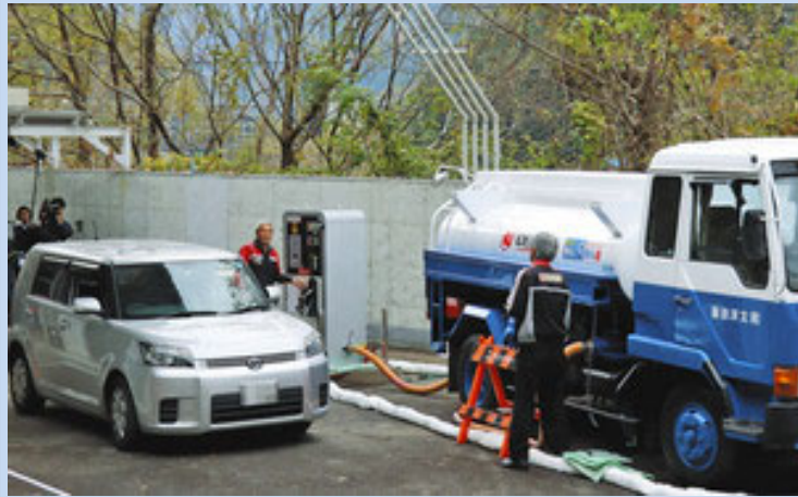
過疎地での移動式給油設備(どこでもスタンド)を活用した新たな燃料供給体制の実証実験(浜松市他)
