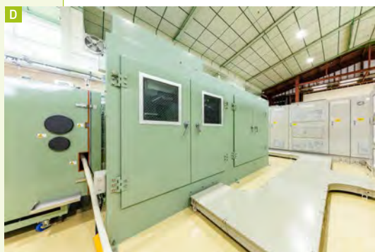
D. モーター特性試験装置により、開発したモーターの評価試験を進めている。
