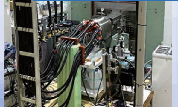
航空機ジェットエンジンに搭載可能なメガワット級電動機の評価の状況(出典:(株)IHIホームページ)
