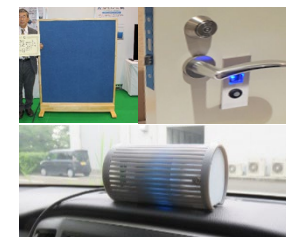
「深紫外LED」を活用した商品化例 （左上）パーテーション （右上）ドアノブ自動殺菌装置 （下）空気清浄機
