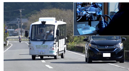
【遠隔操作による自動運転の様子】
