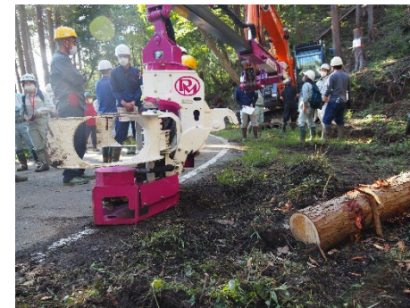
労働生産性等の実証～ロングリーチ伐倒機～
