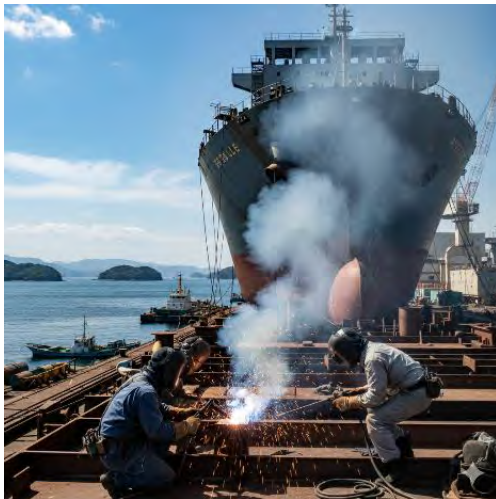
手作業での溶接
