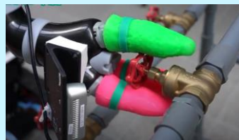
メータ読み取りロボット Auto meter handling
