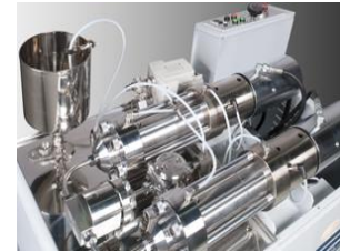
ウォータージェットを活用した微粒化装置 (株)スギノマシン
