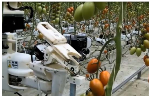
アームを伸ばし、ロボットハンドで収穫
