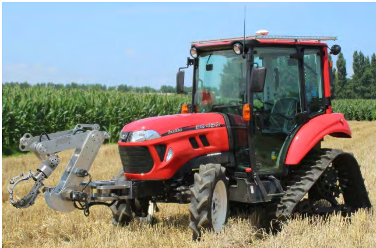
ハンド付きロボットトラクタ
