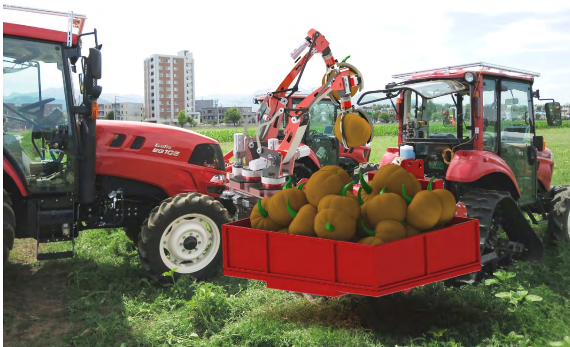
ハンド付きロボットトラクタ
