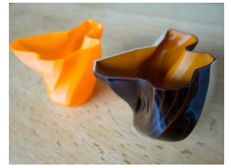
3Dプリンターで作成した漆製品の試作
