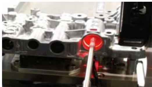
レーザー傷自動検査装置 （量産ラインの目視検査を自動化）
