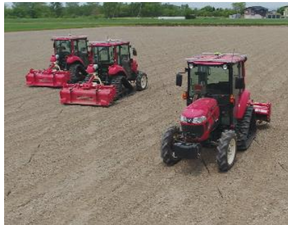
ロボット農機(無人トラクター)による 4台協調作業実証試験(岩見沢市)
