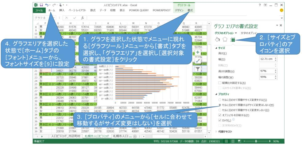
グラフを選択した状態でメニューに現れる[グラフツール]メニューから[書式]タブを選択し、「グラフェリア」を選択し[選択対象の書式設定]をクリックすると、ウィンドウの右側に上記のような設定画面が表示されますので[サイズとプロパティ]のアイコンを選択し、[プロパティ]のメニューから[セルに合わせて移動するがサイズ変更はしない]を選択します。この設定によってグラフの大きさを調整したときにフォントのサイズが変更されないようにします。またその後グラフェリアを選択した状態で[ホーム]タブの[フォント]メニューから、フォントサイズを[9]に設定します。
