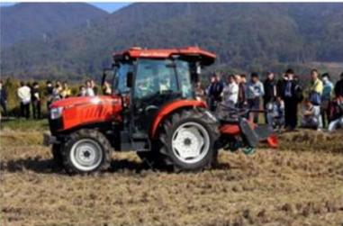
無人の自動運転で耕運作業を行うトラクター。人が近づくとセンサーで止まる（京都府亀岡市保津町）
