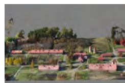
ドローンを使用したSfM写真測量 による3Dモデリングデータ
