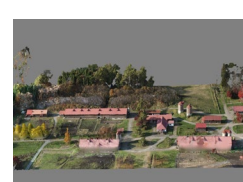
ドローンを使用した S f M 写真測量 による 3D モデリングデータ
