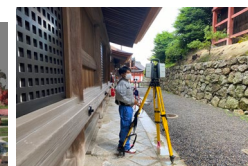
3D レーザ計測の作業状況
