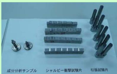
試験片による材料試験(引張、疲労、衝撃)
