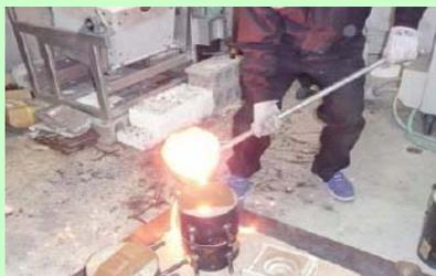
船舶鉄スクラップの溶解・試験片の鑄造
