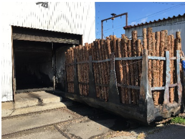
窯の中では 600℃で 10～12 日間程度燃焼し木炭にする
