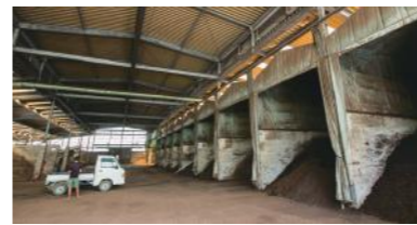
堆肥の発酵槽は全部で10槽。空気がないと生きられない好気性菌をつかい、堆肥独特の臭気はほぼない。「革靴でも入れる施設」を目指し、徹底した衛生管理に取り組む。
