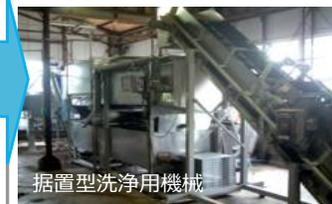
・工場の据置型の洗浄用機械施設により、農作物に付着した火山灰を洗浄し、商品性の低下を防止します。
