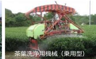
・乗用型洗浄用機械施設により、農作物に付着した火山灰を洗浄し、収量及び商品性の低下を防止します。
