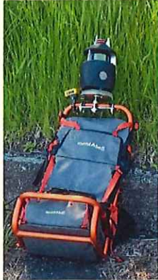
空間測量先端機器の1種であるバックパック型3Dレーザースキャナ (2018年加藤学園御殿場キャンパスにて)
