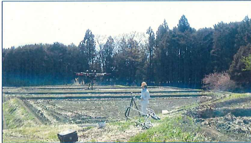
河川台帳作成に向けて護岸形状・植栽・川幅等をドローン測量した先行実験(2018年)
