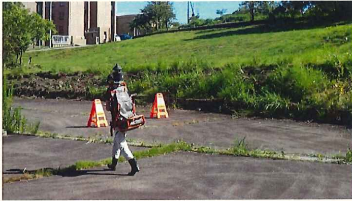
空間測量先端機器の1種であるバックパック型3Dレーザースキャナ (2018年加藤学園御殿場キャンパスにて)
