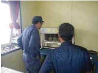
沈殿処理技術確認 (ジャーテスト)
