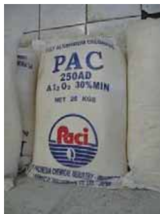
日本製凝集剤（PAC）の活用 （凝集沈殿効果の向上）
