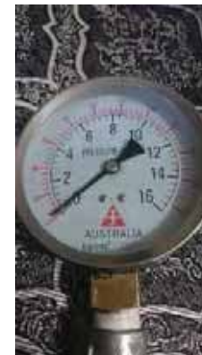
末端配水圧力測定 (配水管網に重大な課題あり)
