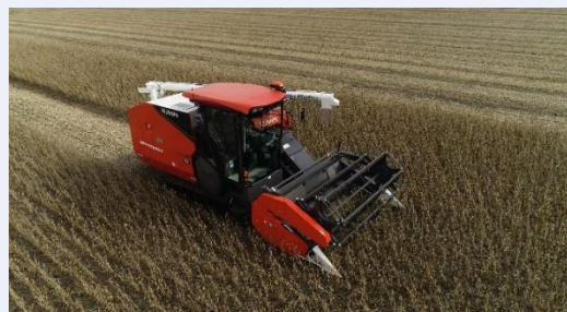
自動運転アシストコンバインによる大豆の無人自動収穫作業
