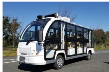
自動運転車両（8人乗りEV）
