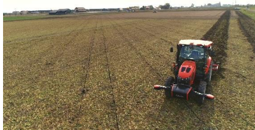
遠隔監視・制御により無人作業を行うロボットトラクター
