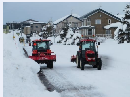
複数メーカーによるスマート農機（ロボットトラクター）の公道での無人によるすれ違い走行
