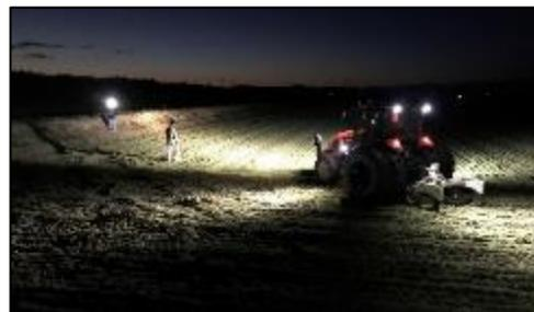
ロボットトラクターによる無人夜間作業（心土破碎）
