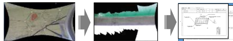
球殻ドローンで近接画像を撮影 近接画像から展開画像の生成 調書作成の支援
