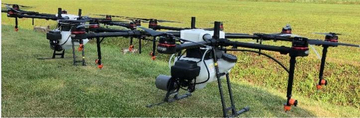
実証で使用した2機の液体散布ドローン
