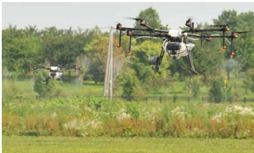
ドローン2台編隊飛行農薬散布
