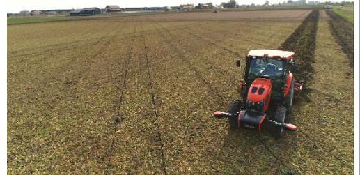
遠隔監視・制御により無人作業を行うロボットトラクター
