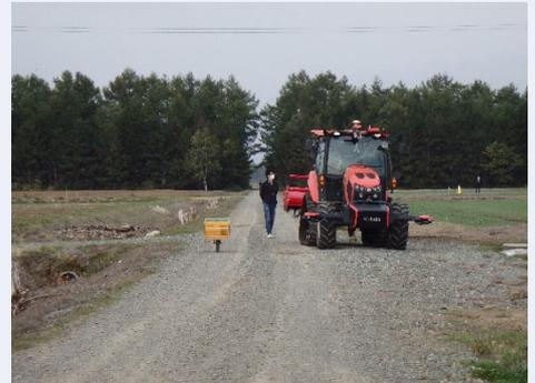
(障害物を遠隔操縦で回避するロボットトラクター)
