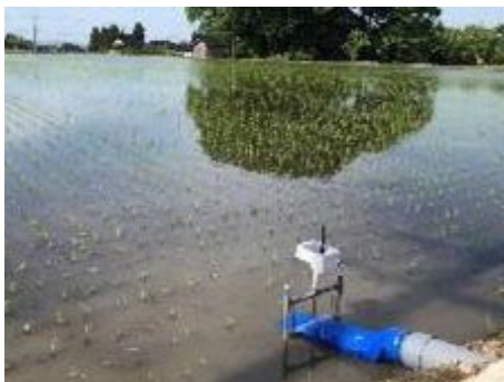
給水ゲートによる水管理の自動化
