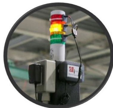
工作機械のパトランプに取り付けられたIoTデバイス
