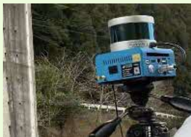
（橋の3Dモデル作成のためレーザー計測装置）
