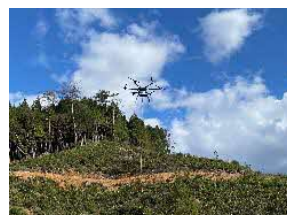
「林業イノベーション実証事業」として大型ドローンを活用した林業用資材の運搬の実証実験の様子。林業の省力化を図る。
