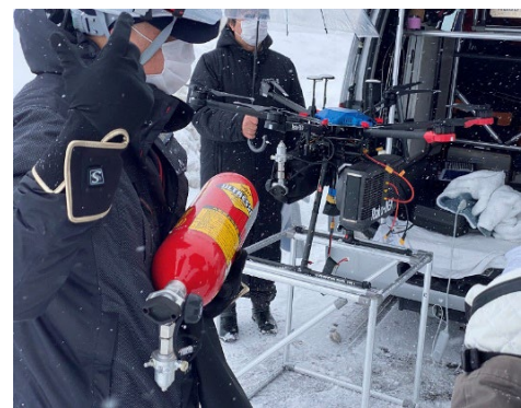
水素燃料ドローン[燃料タンク]
