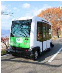
公道でのレベル4 自動運転実証実験
