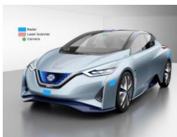
ニッサンIDSコンセプト センサーレイアウト
