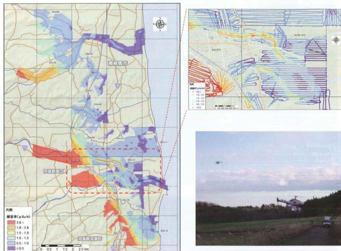
図2-2-1 無人ヘリコプターによる放射線分布測定例
