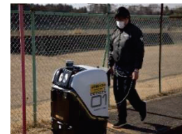
配送ロボット(FORRO) 使用機体(PD6B-TYPE3)
