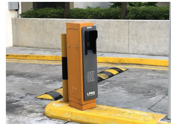
車のナンバーを読み取、建物内への入場管理を 自動化するスマートカメラ
