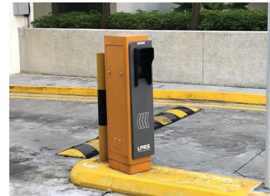
車のナンバーを読み取、建物内への入場管理を 自動化するスマートカメラ
