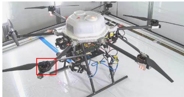
マーキングによるネジの緩み確認
