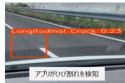
車載のカメラ画像とドローン空撮 画像のアプリ解析結果の比較
