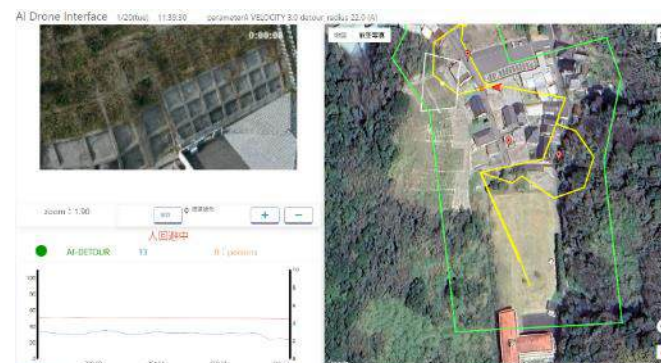
第三者検知および自動生成された飛行ルートを確認するためのWebUI
