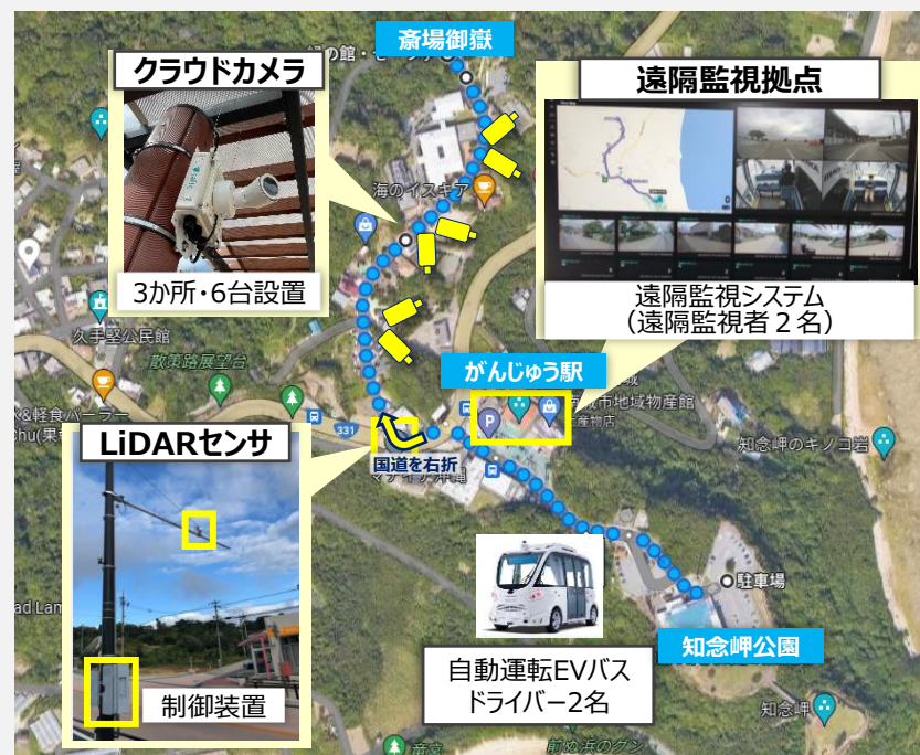
走行ルート上に設置した機器や遠隔監視拠点等
