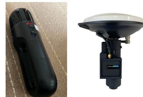
（左）SLAM用スキャナLeica BLK2GO （右）RTK-GNSS計測に用いた Dropper RWXのアンテナ受信機部分
