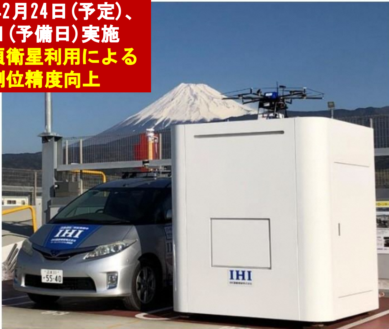
ドローンの離発着場となるドローンステーション（ドローンポート） 2m×2m×2.2m（縦×横×高さ）
