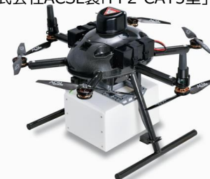
レベル4飛行はいずれも株式会社ACSL製「PF2-CAT3型」を使用
