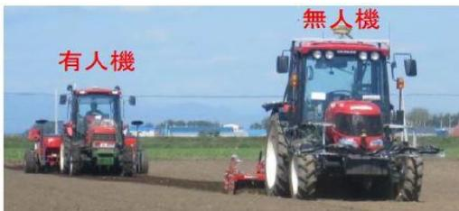
・写真は、衛星測位技術を用いて自動走行するトラクター
